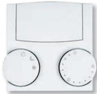
**FE 7** | Die Fernbedienung mit Raumtemperaturfühler übernimmt die Einstellung der Raumsollwerttemperaturen. Darüber hinaus wechselt sie zwischen den Betriebsarten Tagbetrieb, Absenkbetrieb und Programmbetrieb. In Verbindung mit dem Wärmepumpenmanager ist sie für beide Heizkreise einsetzbar.
